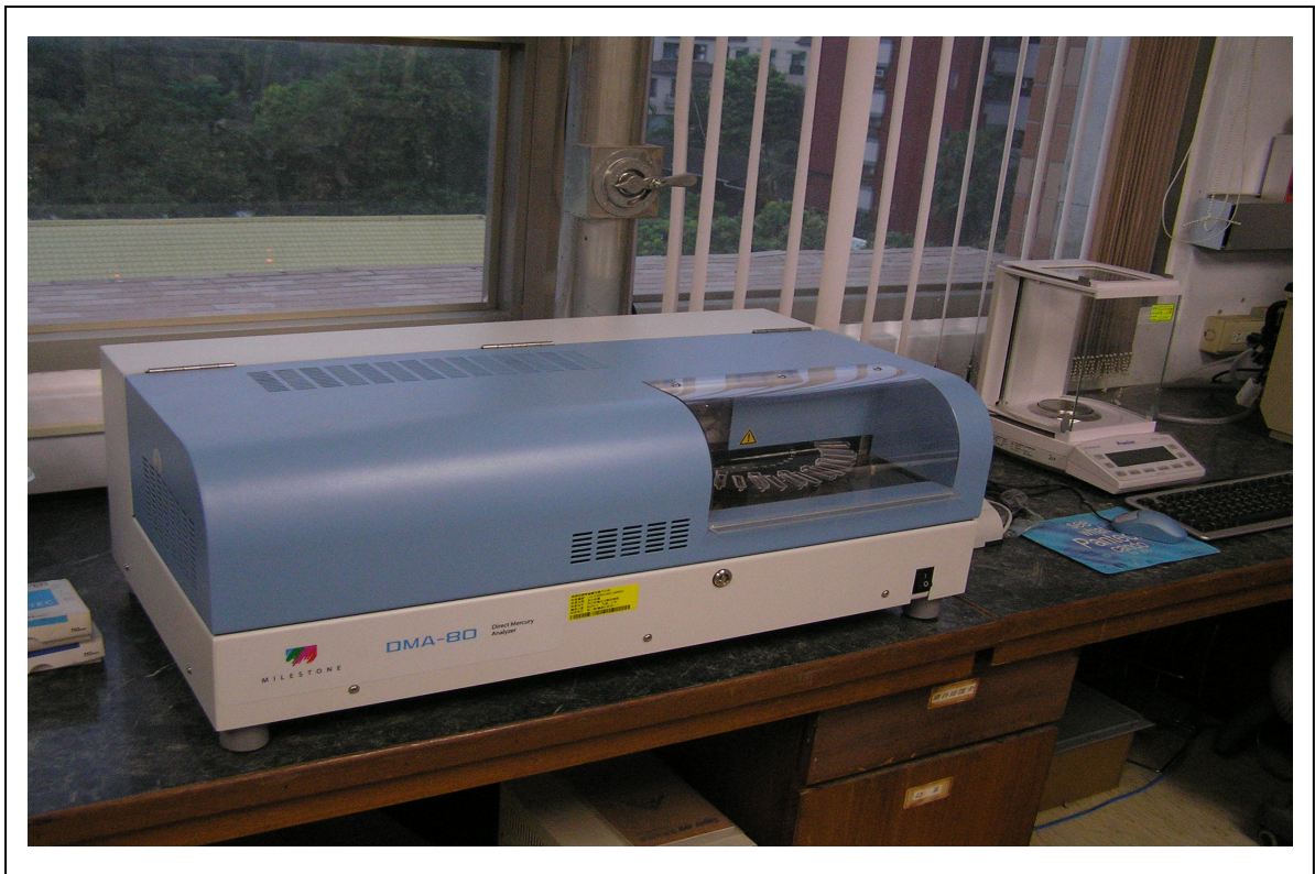
圖 3-5 Milestone DMA-80 型熱分解汞齊原子吸收光譜儀
