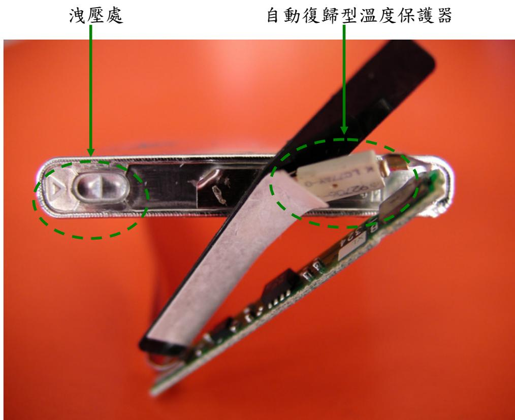
圖 3-4. 故障鋰二次電池內部
