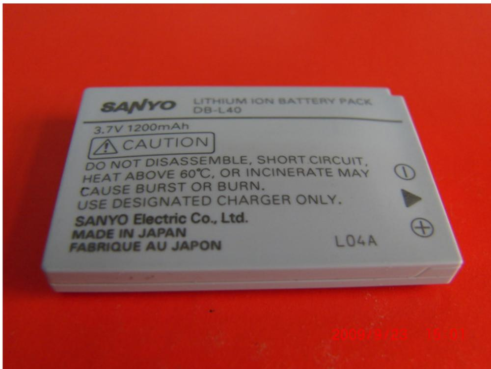
圖 3-3. 故障鋰二次電池外觀(1/2)
