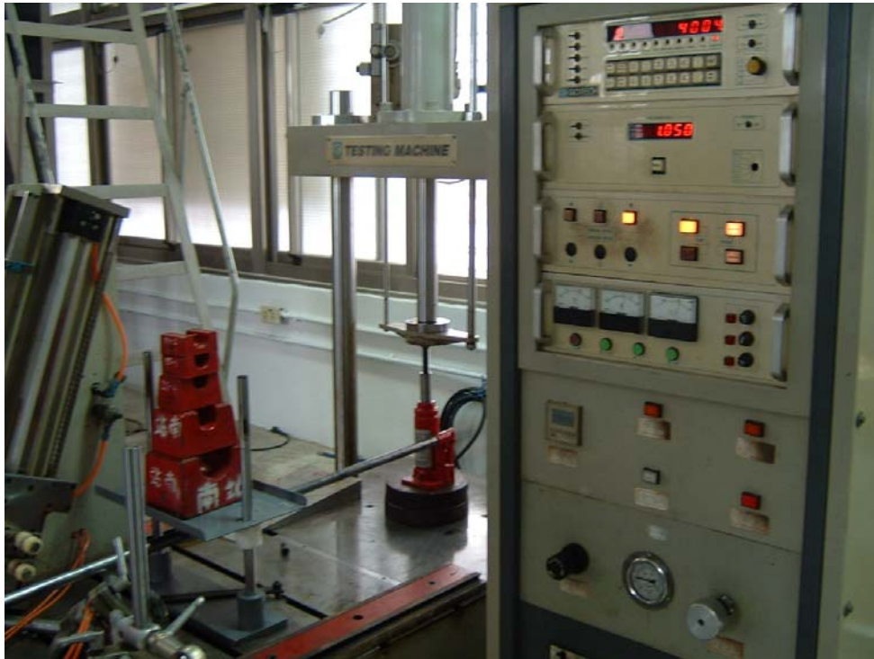
圖 3-4：5/10 噸千斤頂抗壓試驗機（高鐵牌/ KT-F159）
