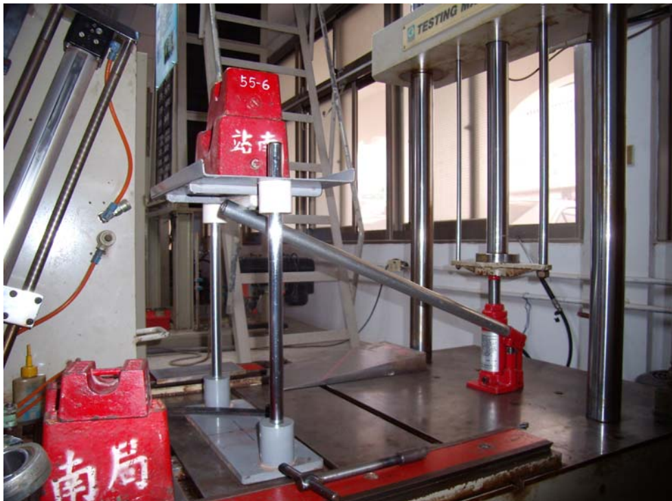
圖 4-1 使用法碼測量槓桿操作下壓所需之力量
