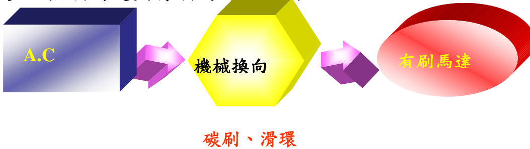
圖 1. 有刷馬達：以機械式整流子或電刷來控制換向動作
