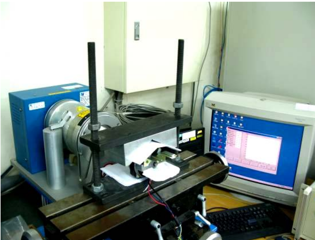
圖 3 馬達特性曲線測試平台
