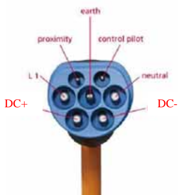
圖 4.5(a)： 歐規 IEC 低功率下直流 充電介面
