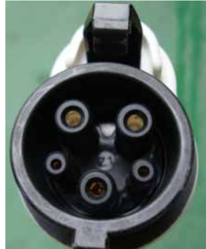
圖 3.12(a)： J1772 AC Type1 接腳 圖 3.12(b)： J1772 AC Type1 實體
