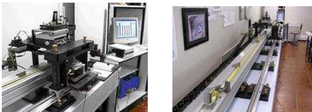
圖 14、直尺和 5 公尺捲尺測量系統
