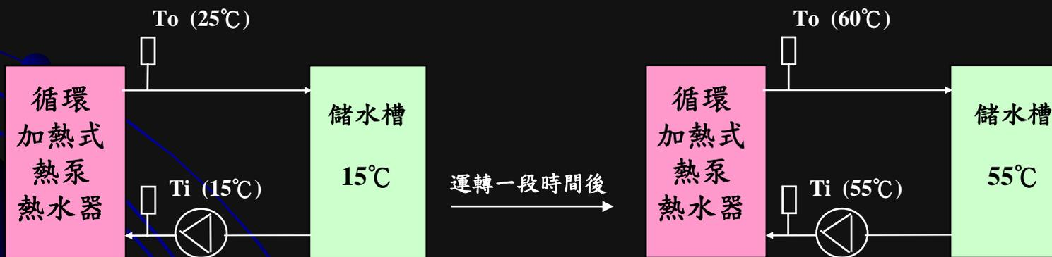
循環加熱式熱泵熱水器圖例
