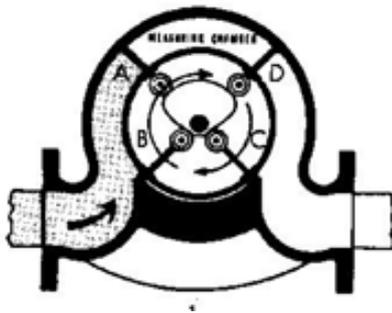
圖1 未測之流體 (黑影部份) 進入流量計。轉子及葉片藉流體動力順時針轉動。
