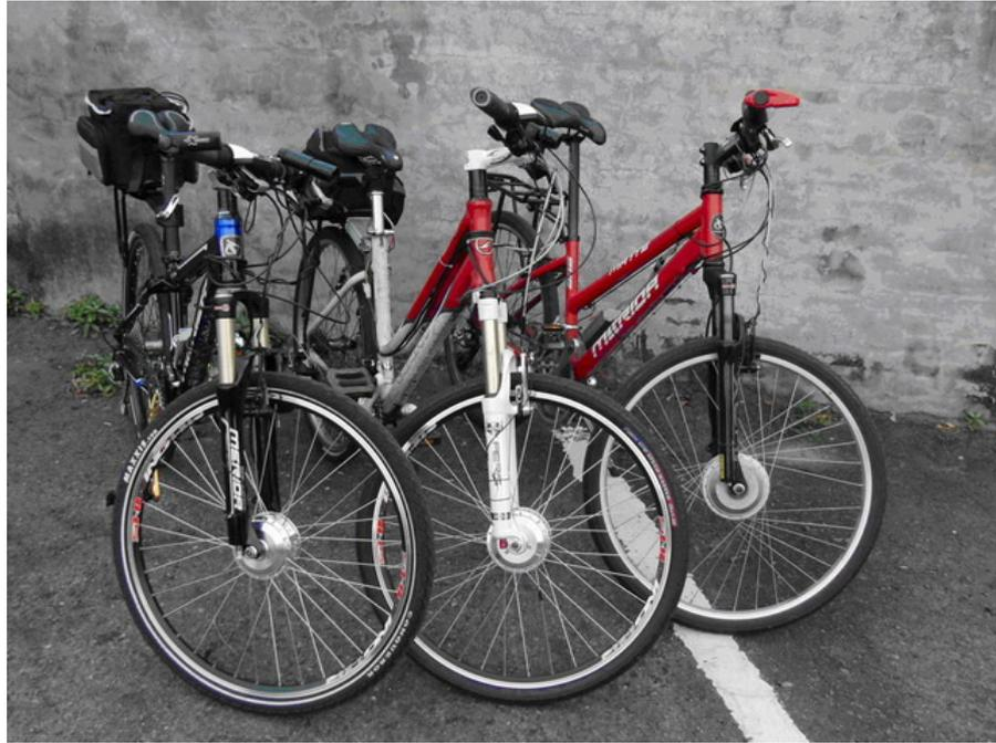
圖 4-2. 安裝於自行車之輪轂電機
