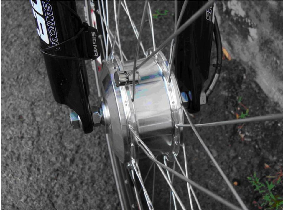
圖 4-5. 3 號樣品車輪轂電機與前叉距離
