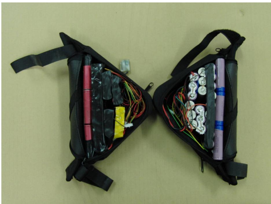
圖 2-7. 36V 7.8AH 二次鋰電池組
