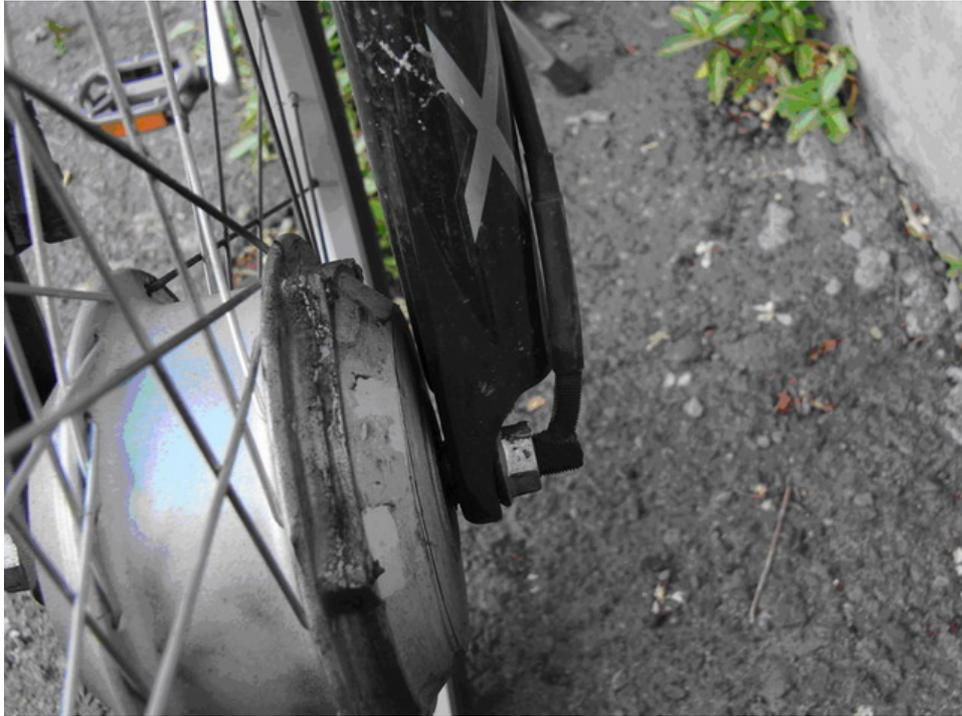
圖 4-3.1 號樣品車輪轂電機與前叉距離
