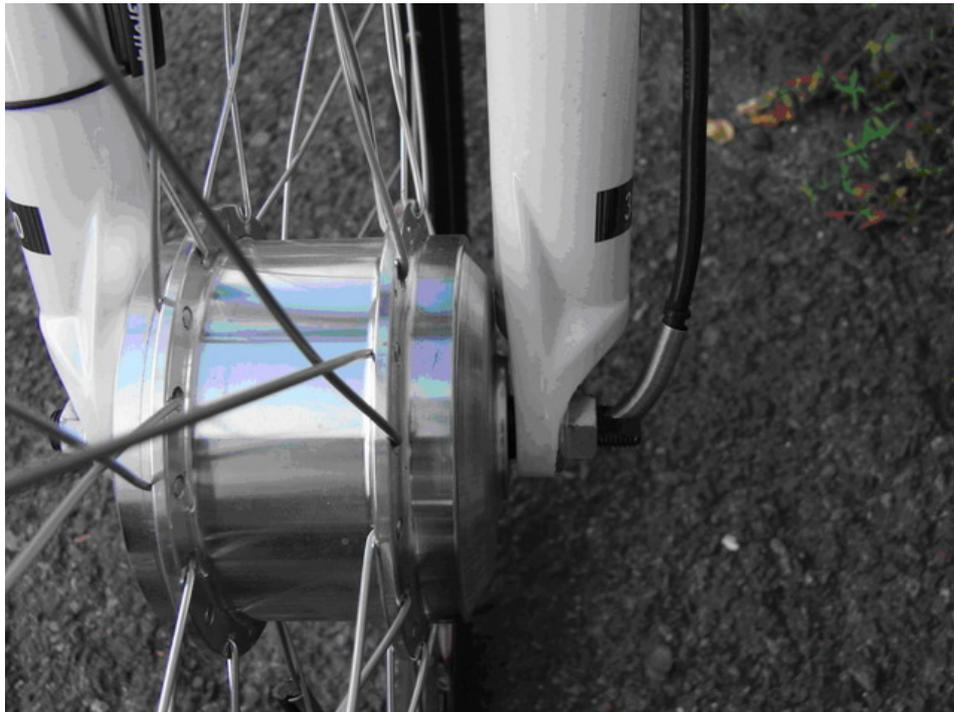
圖 4-4.2 號樣品車輪轂電機與前叉距離
