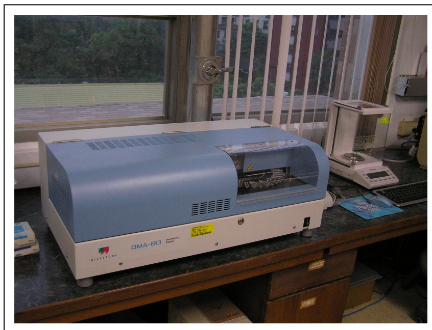
圖 2-2 Milestone DMA-80 型熱分解汞齊原子吸收光譜儀
