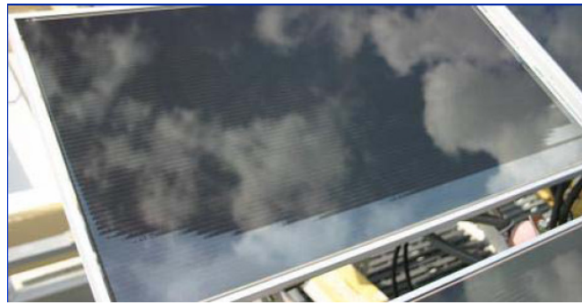
圖15 -300V 偏壓模組 30 個月後的損壞範圍實體照片[5]
