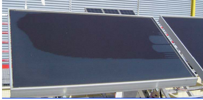
圖14 -600V 偏壓模組 24 個月後的損壞範圍實體照片[5]
