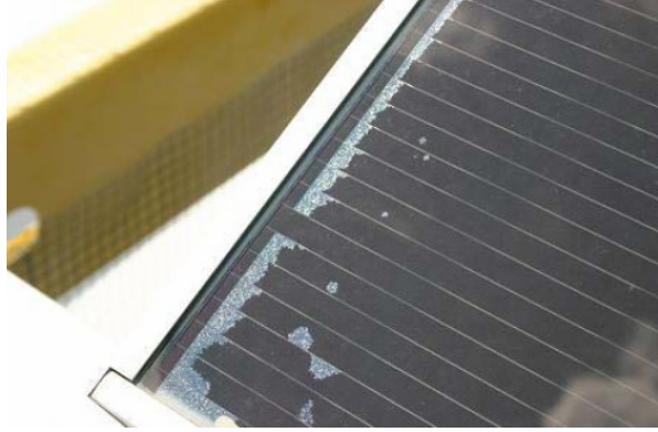
圖17 無偏壓模組 30 個月後的損壞範圍實體照片[5]
