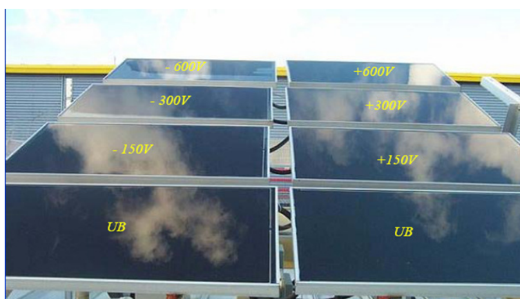
圖13 偏壓大小與 TCO 腐蝕現象關係實驗配置圖[5]
