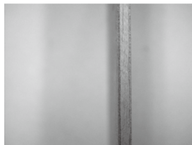
一般合板側面 (芯板 2.5mm，上下 夾板各 0.65mm，總厚度 3.8mm)
