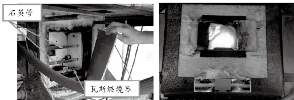
圖 2-2 將試體置入表面試驗機燃燒裝置內，加熱燃燒過程共 10 分鐘，前 3 分鐘為瓦斯單純加熱，後 7 分鐘則為瓦斯及石英管共同加熱（以耐燃二級為例）。
