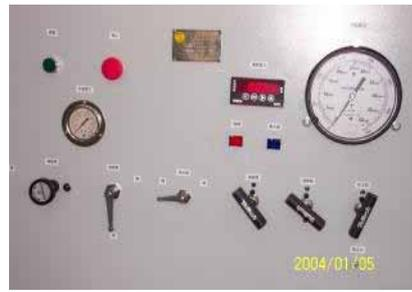
高壓鋼瓶試驗設備面板
