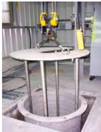
高壓鋼瓶爆破固定架
