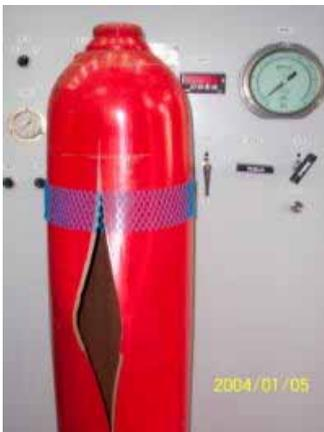
高壓鋼瓶爆破情形
