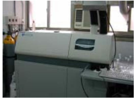
圖一 感應耦合電漿原子發射光譜儀
