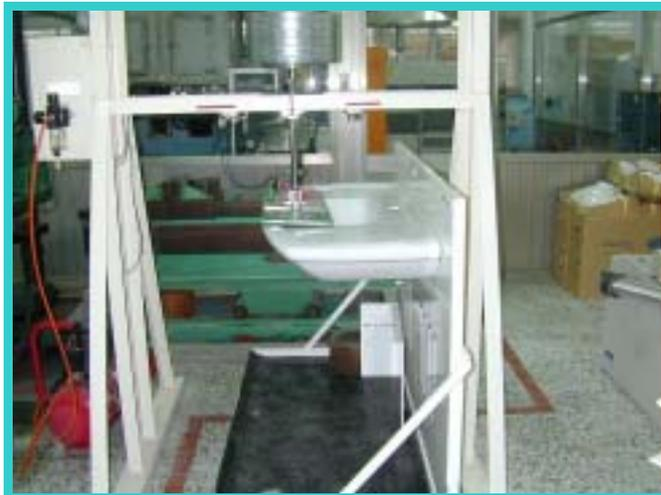
(圖說：壁掛式陶瓷臉盆載重性試驗設備)
