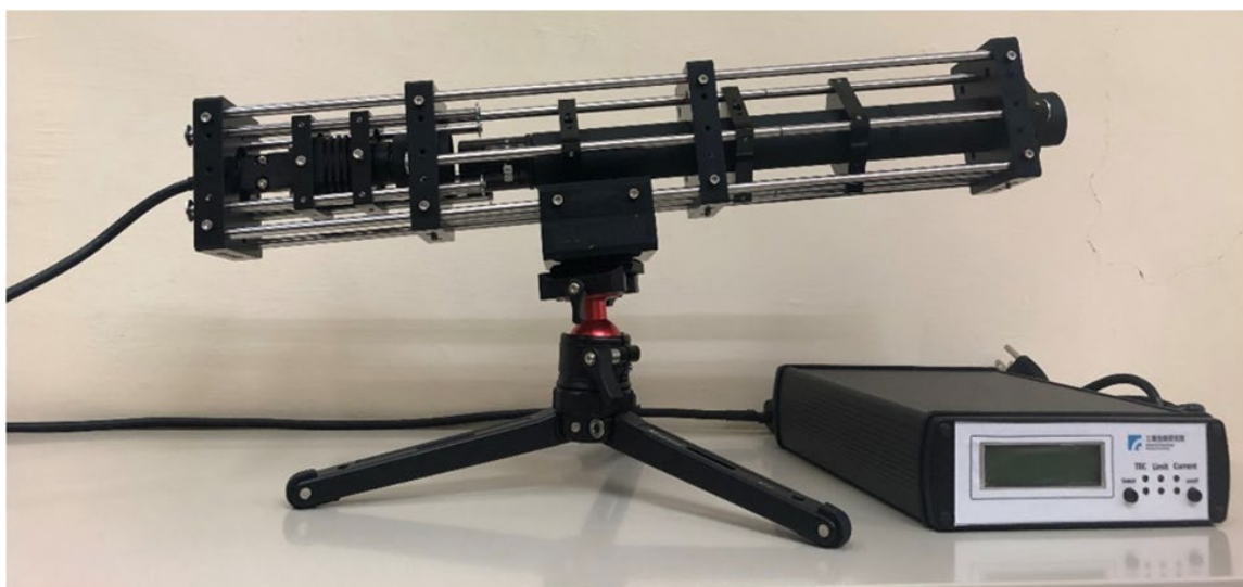
圖 72、黑體模擬器外觀圖(含校正用準直鏡組)
