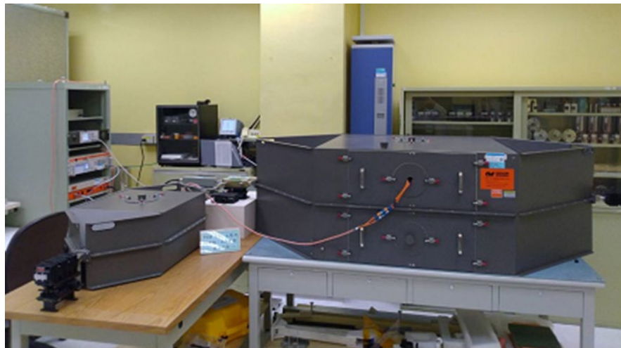
圖 73、(0.1-500) MHz 橫電磁波室高電磁場強度量測系統架設圖
