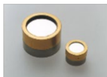
a. 實驗室標準麥克風 符合 IEC 61094-1 LS
