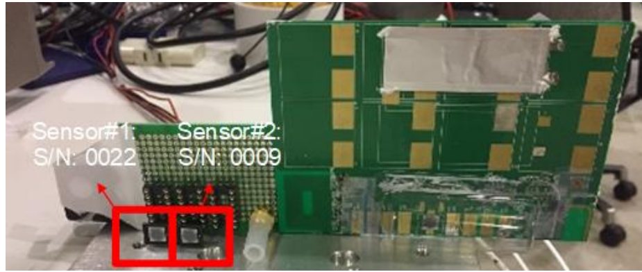
圖 2-3-12、EUV 光偵測器響應標準傳遞測試用之標準件(左)與待校件(右)。
