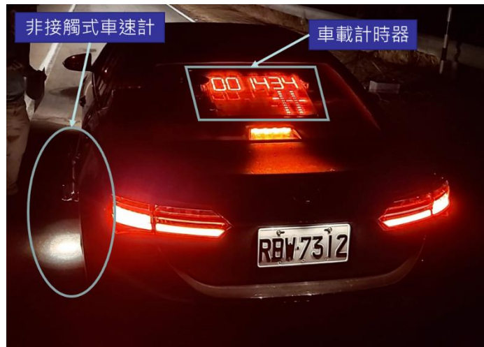
圖 3-3-2、安裝車載計時器與非接觸式車速計之測試車輛
