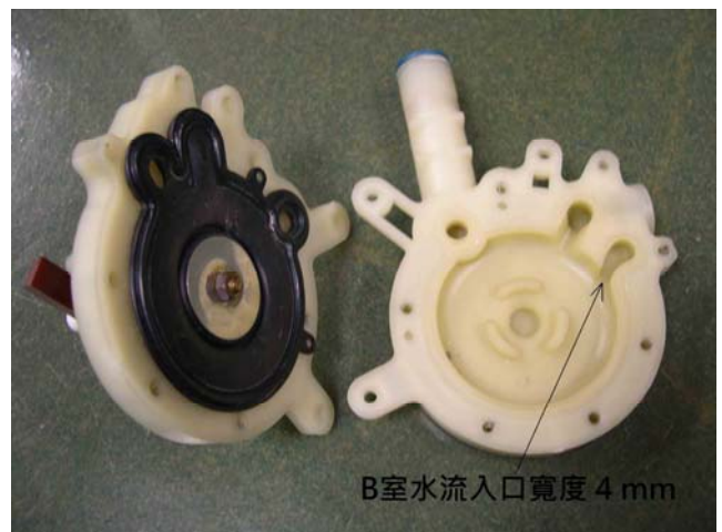
圖3b本案水盤開關結構及通道口徑尺寸
