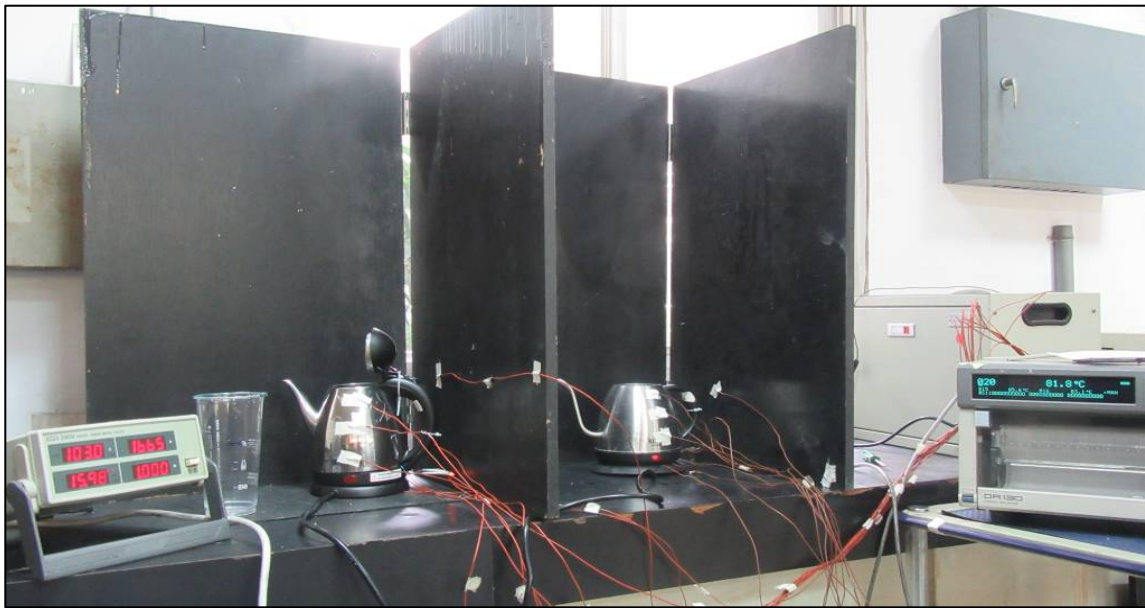
c. 兩款快煮壺同功率、同壺體容量、外觀相似、同水位下, 同時啟動試驗
