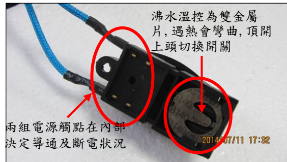
b. 手動切換開關由底部內藏沸水溫控動作
