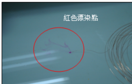
(b)漆膜若有破洞即顯紅色漂染情形
