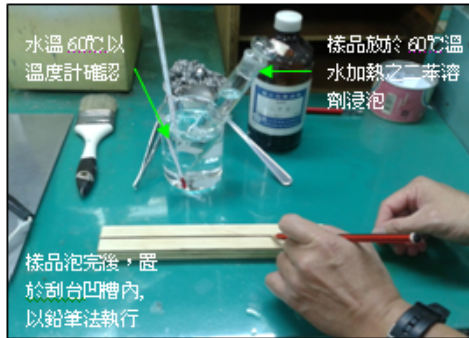
圖 8 漆包線耐溶劑性試驗
