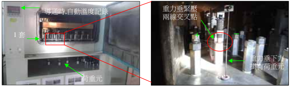
(a)耐軟化試驗機台(可同時進行五試片) (b)固定方式及重力垂施力情形
