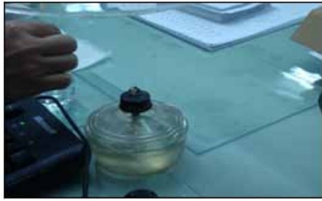
(a)量測銅導體直徑前先以火去膜厚
