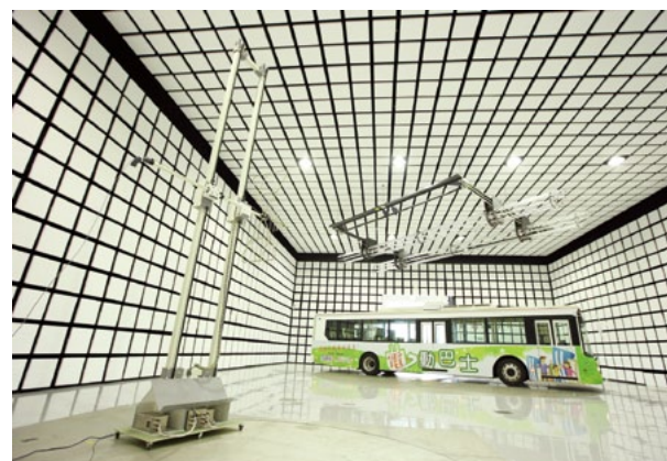
▲ 圖1、整車電磁干擾暨整車天線3D場型量測系統
