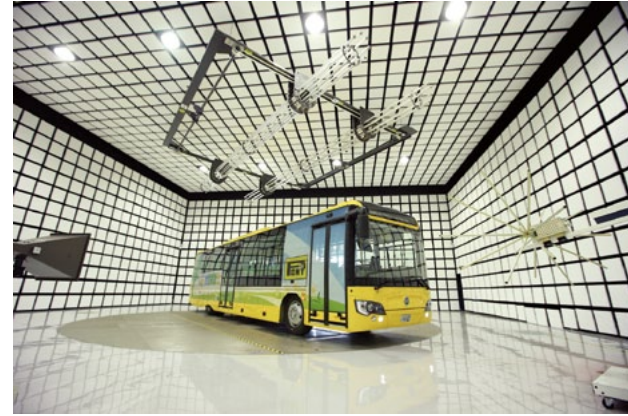
▲ 圖2、以各頻率發射天線執行之整車電磁耐受測試
