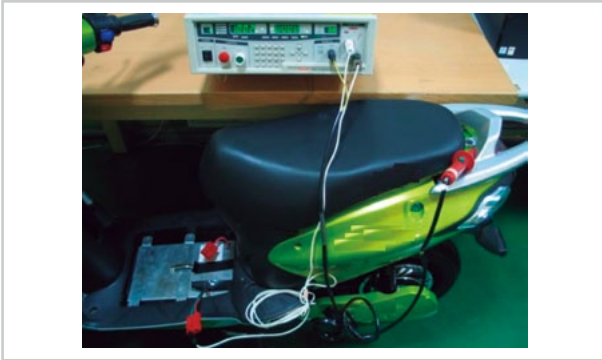
▲ 圖5、電路絕緣電阻量測
