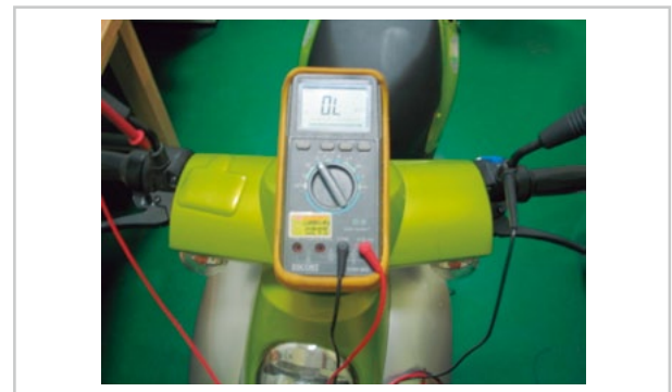
▲ 圖7、任意兩個外露可導電零件間電位平衡連續性
