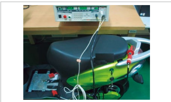
▲ 圖6、介電強度試驗
