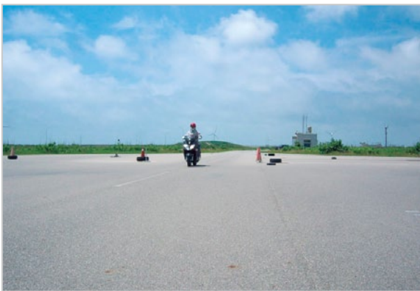
▲ 圖6、執行美國CFR40 Part 205機車加速噪音情形
