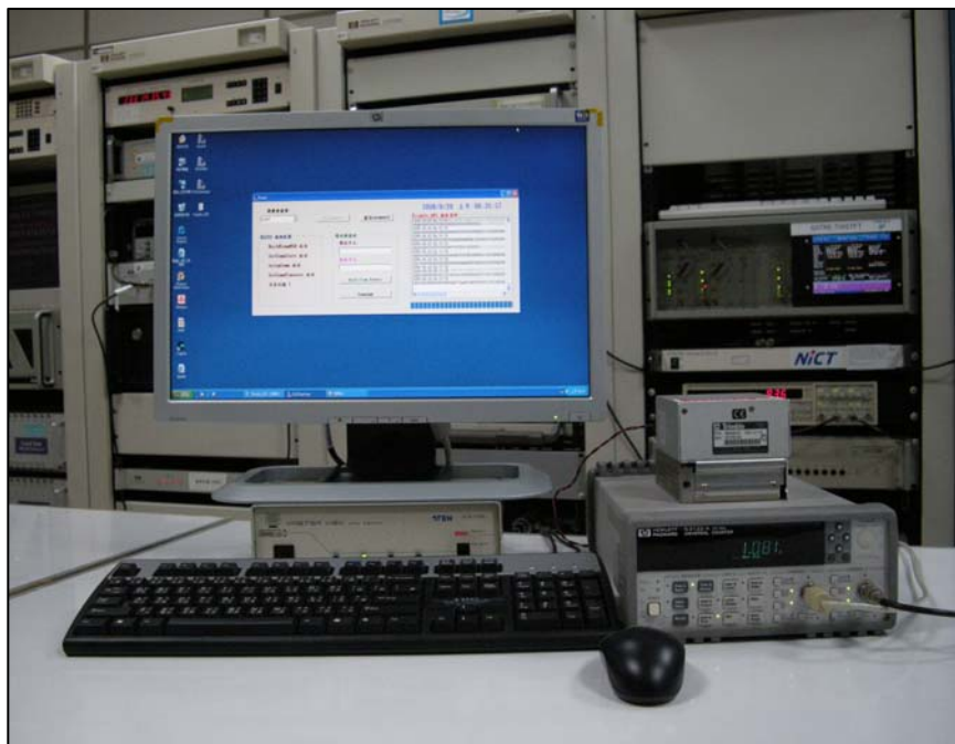
圖 2.2 GPS 共視法系統元件組成
