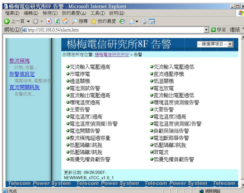
圖 1.8、直流電源系統的告警監控
