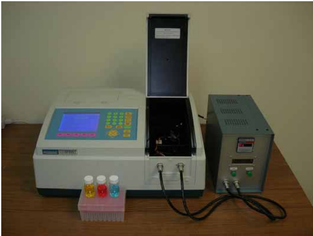
圖 3-3 微奈升液體分注量測儀
