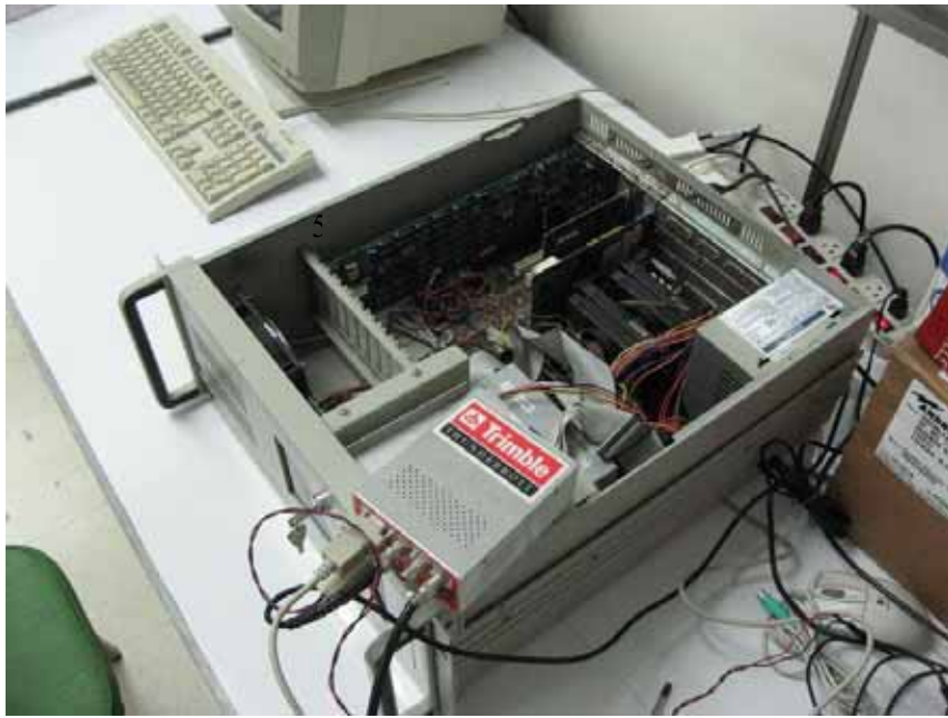
圖 2.1.1 GPS AV 觀測站以 Linux 為平台之硬體系統， (a) GT200 Time Interval Card, (b) Trimble Thunderbolt GPS Receiver
