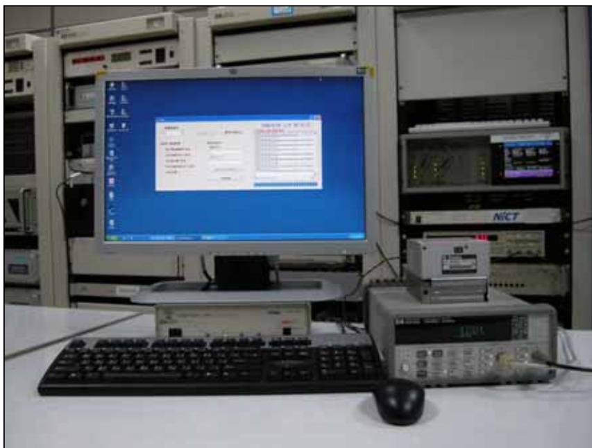
圖 2.1.2 GPS AV 觀測站以 Windows XP 為平台之硬體系統， (a) GT200 Time Interval Card、(b) Trimble Thunderbolt GPS Receiver
