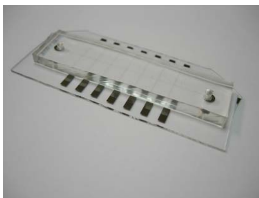
圖 3-5 PDMS 微流道之量測晶片
