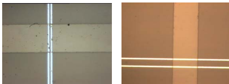
圖 3-15 多次使用後之偵測電極照片：鋁電極(左)；鈦電極（右）
