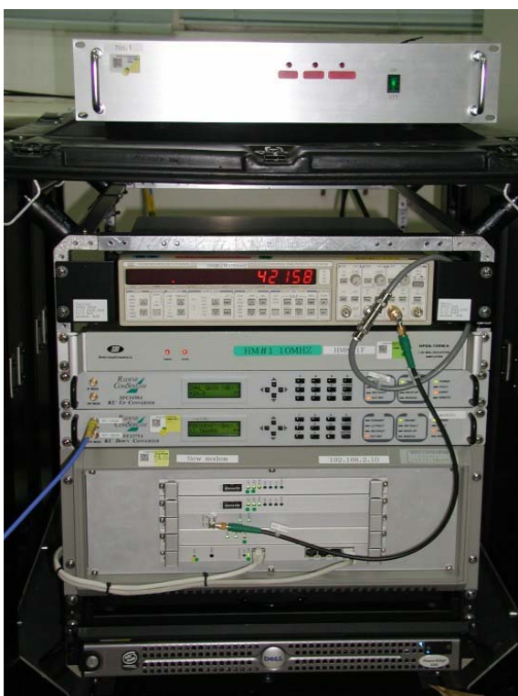
圖 2.2.A.3、(左)可攜式衛星地面站的室內控制設備(包括 2 channel modem、up/down converter、counter 及控制電腦等)。(右)光電轉換器(使用光纖來傳輸發射/接收信號)。
