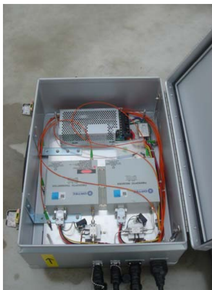
圖 2.2.A.3、(左)可攜式衛星地面站的室內控制設備(包括 2 channel modem、up/down converter、counter 及控制電腦等)。(右)光電轉換器(使用光纖來傳輸發射/接收信號)。
