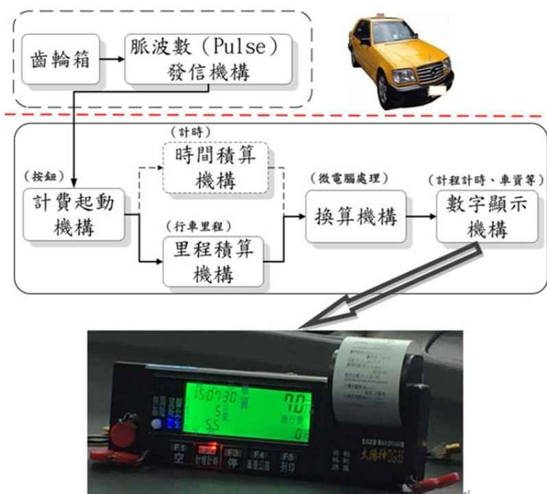
圖 1 計費表之動作流程簡單示意圖
