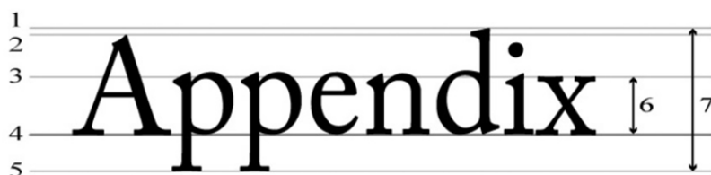
圖一 字號之 X 高度定義（圖中數字 6 所指示的高度）。
