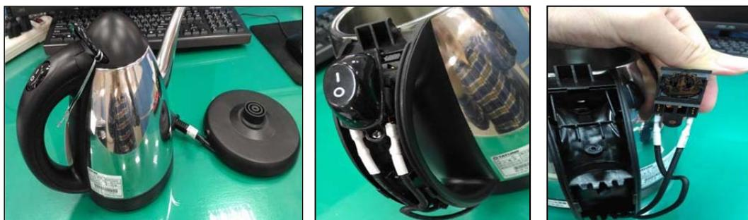
a.快煮壺外觀及分離電源機座      b.手把（含切換開關）      c.切換開關下的沸水溫控
