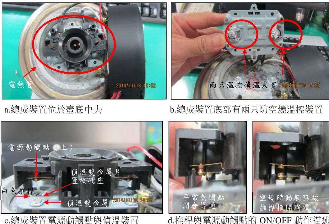
圖 7 防空燒總成裝置的外觀與動作原理
