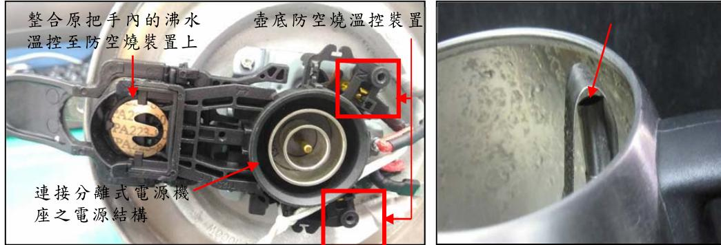
c.沸水溫控整合防空燒溫控，套上一只手動切換開關 d.底部沸水溫控偵測蒸氣之引入管路
