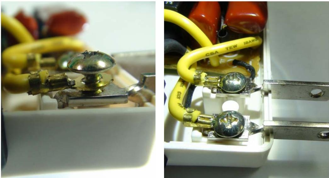
圖 11 為緊固帶電體螺釘兼作固定用（鎖進塑膠外殼固定）
