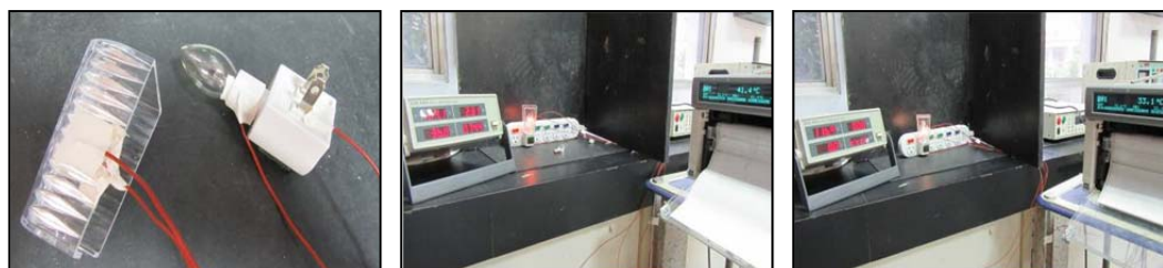
a.熱電偶黏貼部位 b.鎢絲燈泡操作在 1.05 P_0 c.LED 燈泡操作在 1.06 V_s
