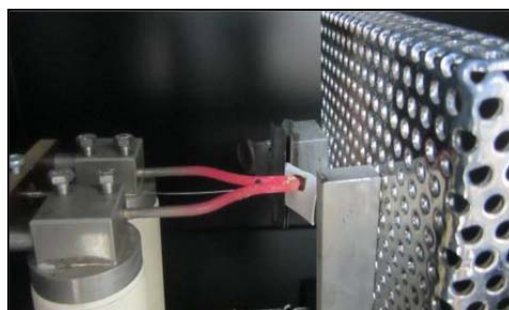
d. 燈罩及插座耐燃試驗，650 °C 熾熱線 熱熔深入 7 mm 止
