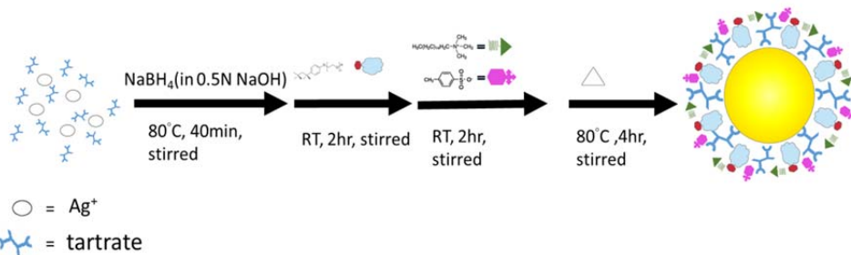
圖 2 一鍋化反應和成銀奈米粒子的示意圖
