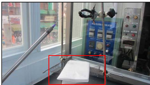
a. 針燄試驗設備(底下鋪棉紙)
