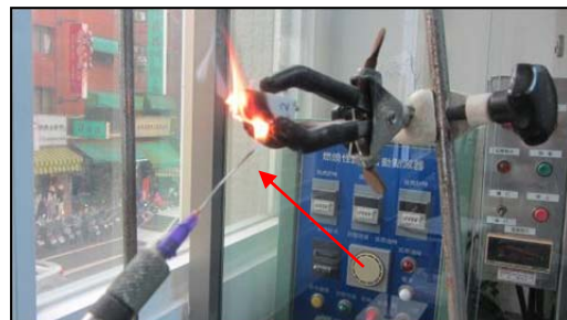
b. 燈座耐燃試驗，針燄測試 10 秒止
