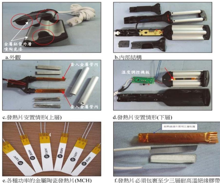
圖 3 三管波浪電捲髮棒結構(購自樣品拆解)
