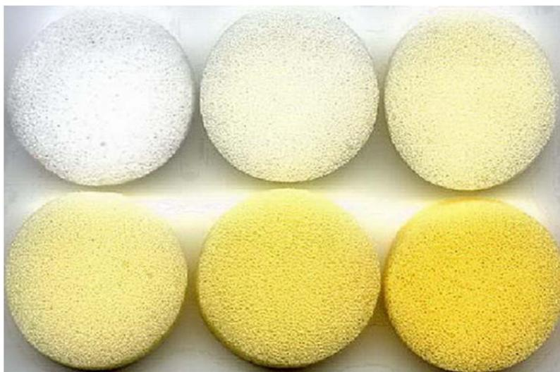
圖 2 泡棉與不同濃度 (0, 37, 73, 147, 293, 587  $\mu\text{g}$ ) 甲醛反應後之外觀。
