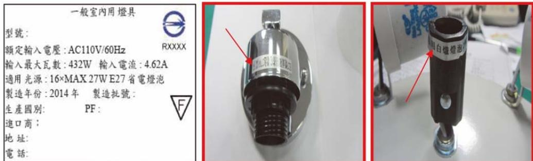
a 燈具整體標示 b 外露燈座標示 MAX 27 W c 外露燈座標示 MAX 2 W
