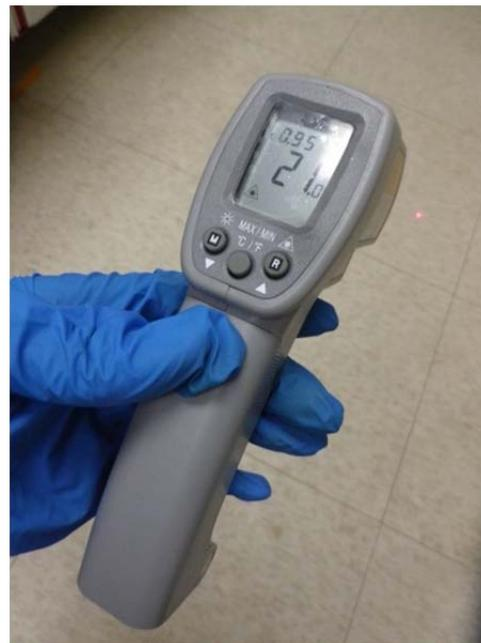
圖 6 紅外線電子溫度計
