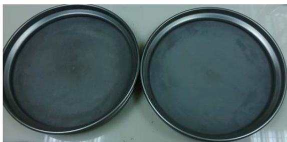
孔徑 20 µm & 32 µm 不鏽鋼篩
