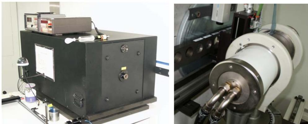
圖1 中能量空氣克馬率校正系統，左圖為國家游離輻射標準實驗室的原級量測標準(自由空氣游離腔)，右圖為該系統X射線照射源及X光射質過濾片系統
