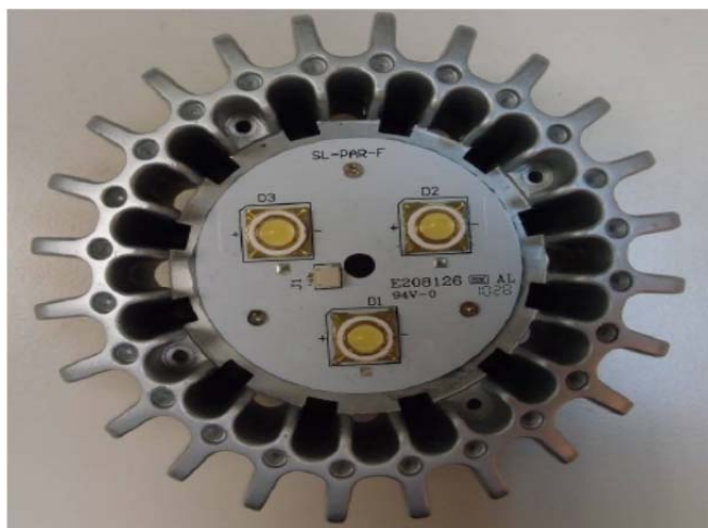
圖 2-7 W 級晶片型二極體組合模組的燈泡 （資料來源：我國某廠商未蓋上燈罩之 LED 燈泡）
