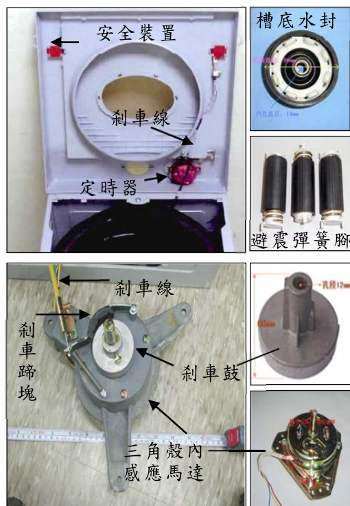
b 前蓋安全裝置、定時器、剎車線、水封裝置、減震彈簧、剎車鼓、三角底座馬達
