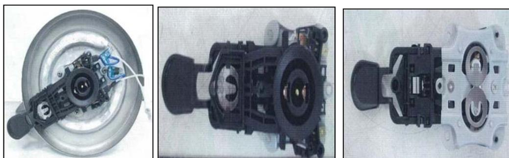
圖 5 手動與自動溫控的整合設計(購樣拆解)
