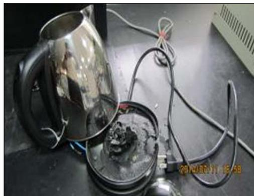
圖 7 防空燒失效試驗情形(實驗拍攝)
