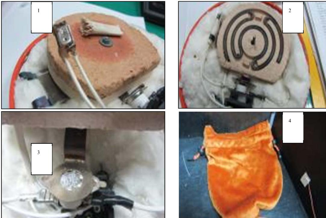
c.組件特寫(1.前衛溫控、2.鐵鎳電阻發線圈、3.後衛溫控、4 隔熱袋)
