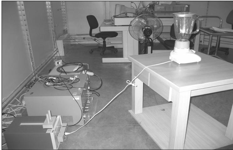
(a)電壓傳導干擾測試
