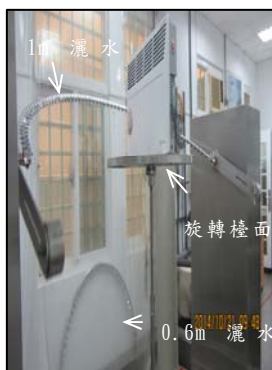
b. IPX4 測試情形(半徑 1M 灑水管/中央旋轉台) (牆壁為半徑 0.6 M 的灑水管適用 IPX2~3 測試)
