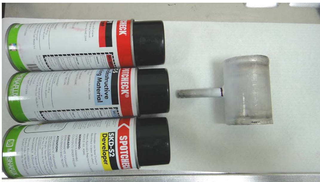
圖 4 三通管進行 PT 檢測
