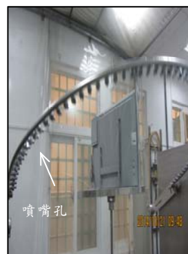
b. IPX4 測試情形(半徑 1M 灑水管/中央旋轉台) (牆壁為半徑 0.6 M 的灑水管適用 IPX2~3 測試)
