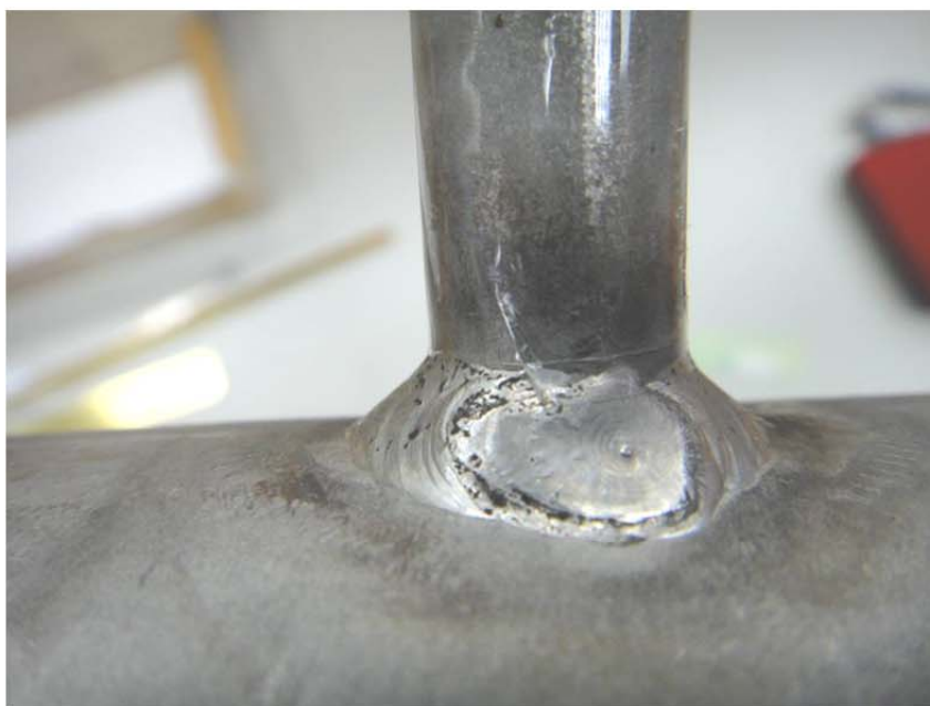
圖 3 插管銲接處銲道收尾銲疤明顯
