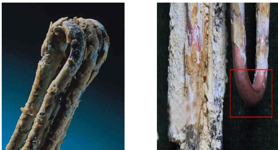
圖 2 加熱管外部結晶物
