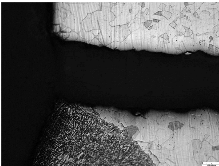
圖 14 銲道斷裂處呈現穿晶破壞型態，倍率 100X
