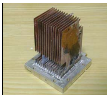
c.鰭片散熱原理(底座為發熱體)
