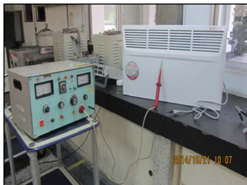
c. 絕緣耐電壓測試
