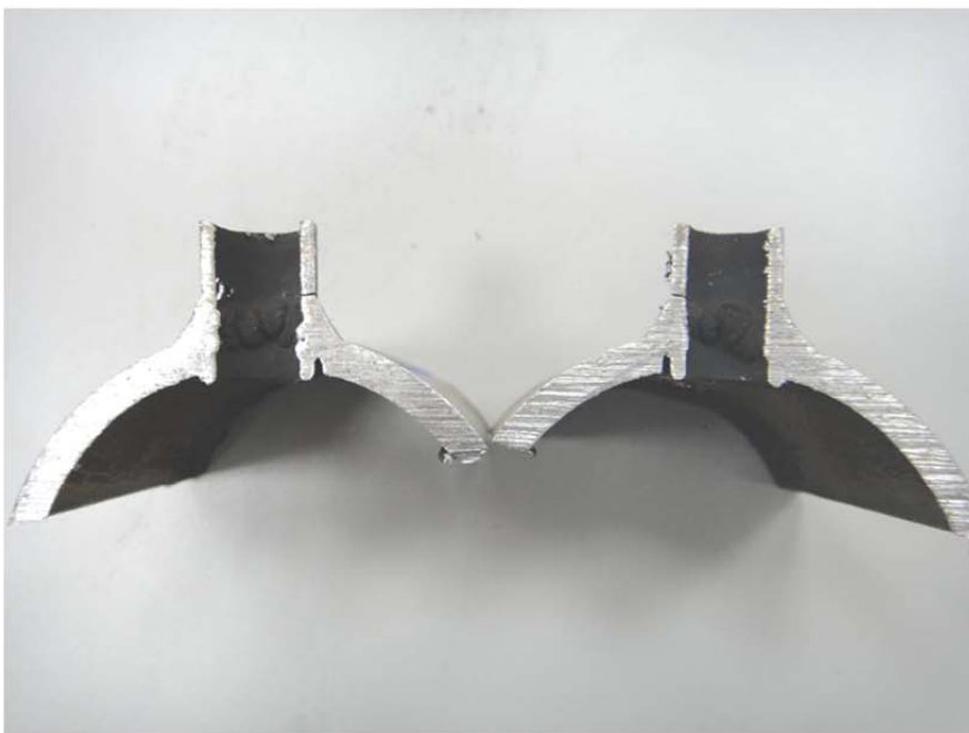
圖 6 將三通管銲接處剖開
