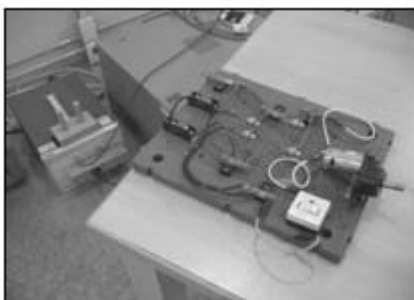
圖 2 干擾源及傳導電壓干擾量測
