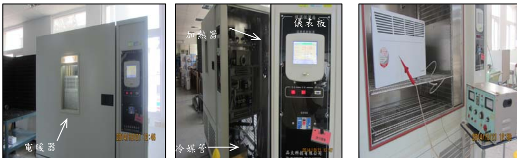
a. 恆溫恆溼箱外觀及其溫濕控制的加熱器與冷媒管
