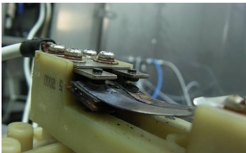
圖 15 事故商品接點開關熔接照片
