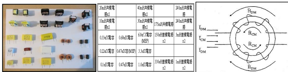
圖 5 分別顯示對策元件實體、對應規格、共模電感纏繞方式與原理
