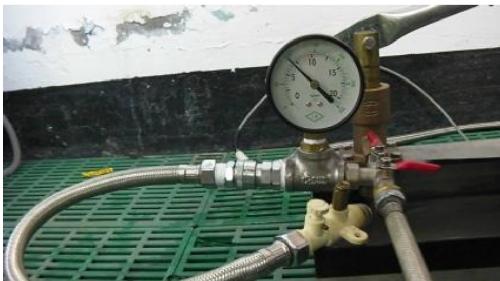
圖 11 壓力閥動作壓力(6~7 kg/cm 2 )
