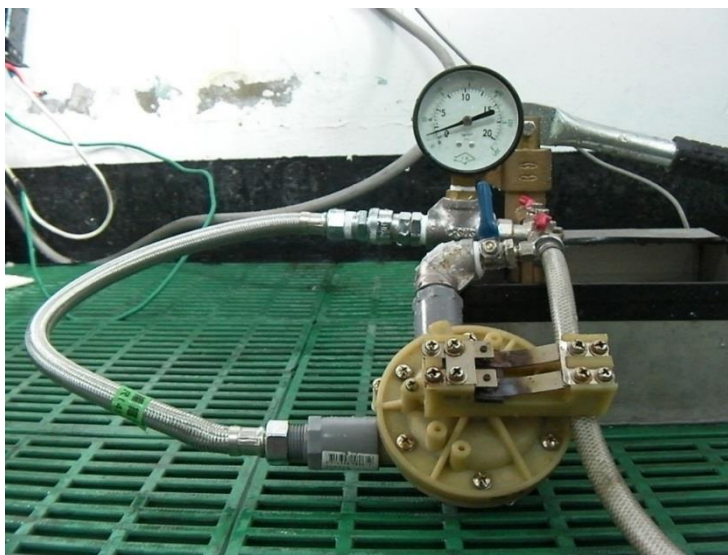
圖 5 水盤開關功能測試
