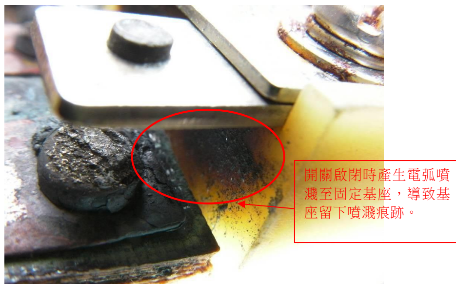
圖 7 老化接點開關(表面氧化、變形、熔接痕跡)
