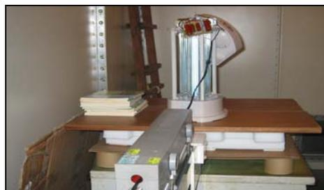
圖 7B 高頻功率輻射干擾量測
