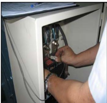
圖 9 電樞繞組電阻量測
