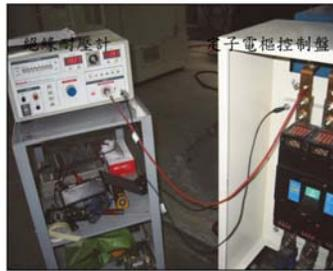
圖 13 電樞繞組施加耐電壓
