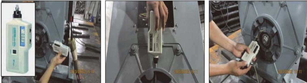
X 軸方向：0.154 mm < 0.3 mm Y 軸方向：0.113 mm < 0.3 mm Z 軸方向 0.037 mm < 0.3 mm
