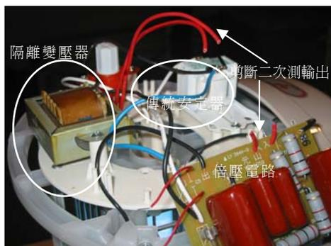
圖 6B (狀況二)僅燈管輸出下量測
