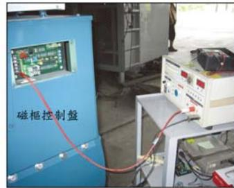
圖 14 磁極繞組施加耐電壓
