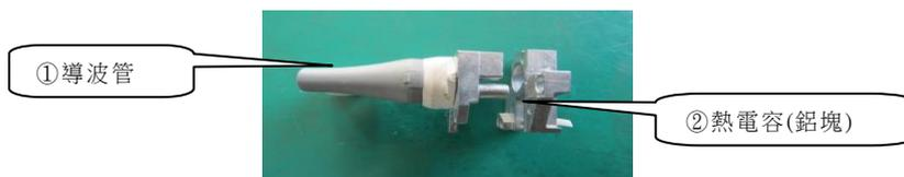
圖 4 導波管及熱電容(鋁塊)
