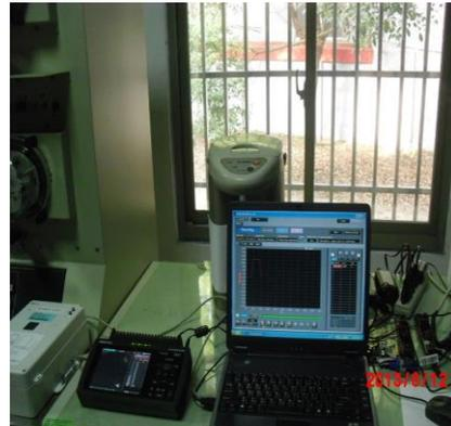
圖 5 B 廠牌電熱水瓶效率測試
