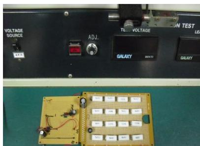
圖 11 整流濾波及降壓水泥電阻器
