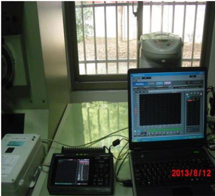
圖 4 A 廠牌電熱水瓶效率測試
