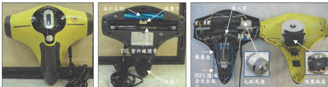
a.外觀 b 吸頭、拍打毛刷、UVC 燈 c.內部結構
