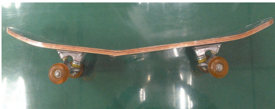
圖 5 滑溜板落下衝擊彎矩破壞實例
