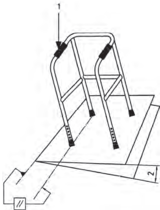
圖 20 側傾穩定性負載配置
