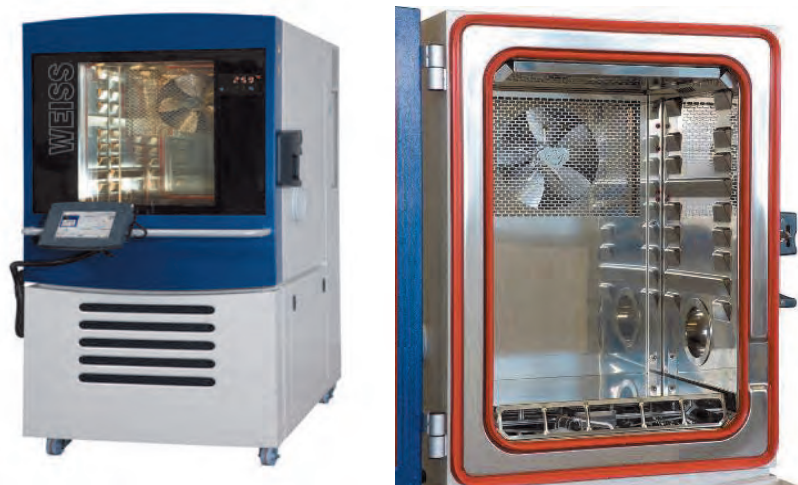
圖 3 環境溫濕度試驗機內外部照片圖例
