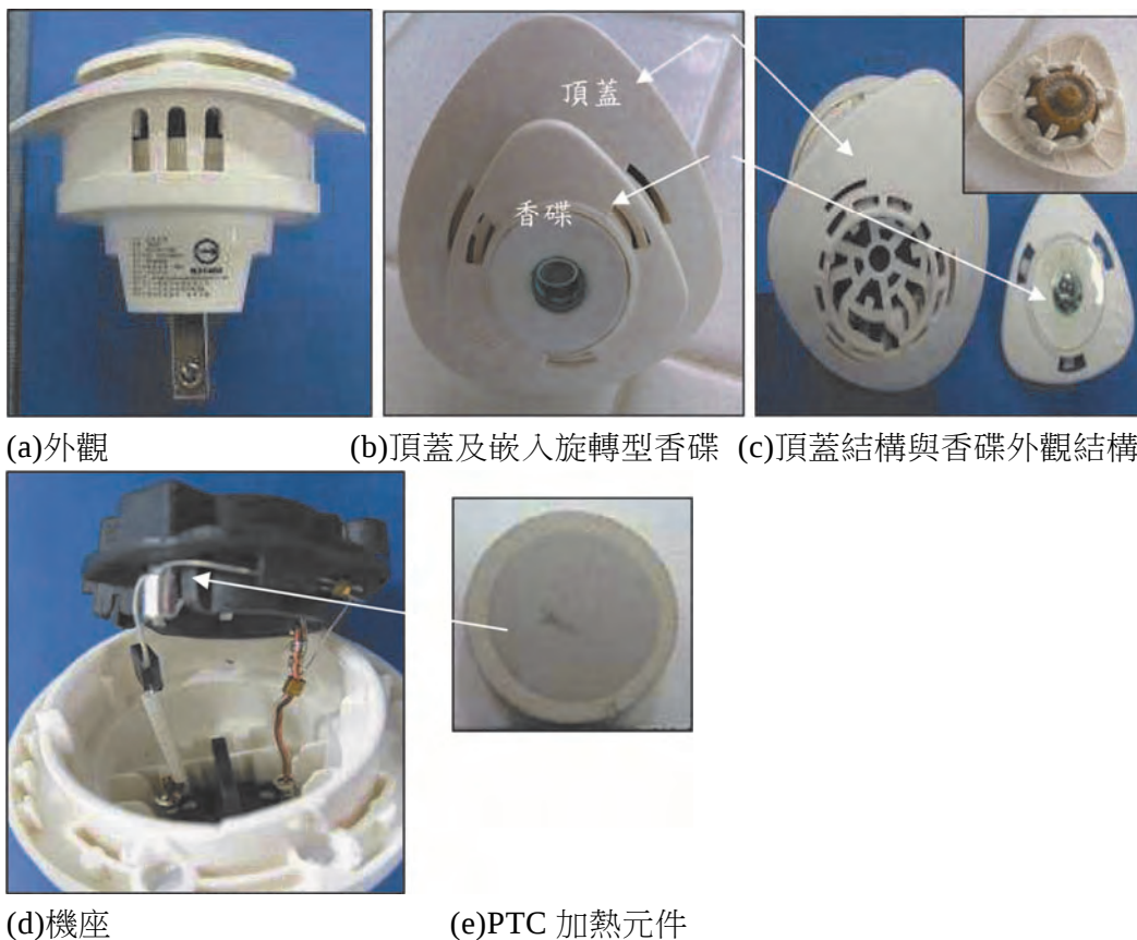
圖 1 電蚊香碟外觀與結構(實體樣品拆解)
