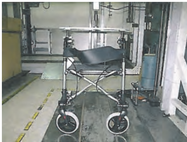
圖 36 靜態負載測試執行狀態
