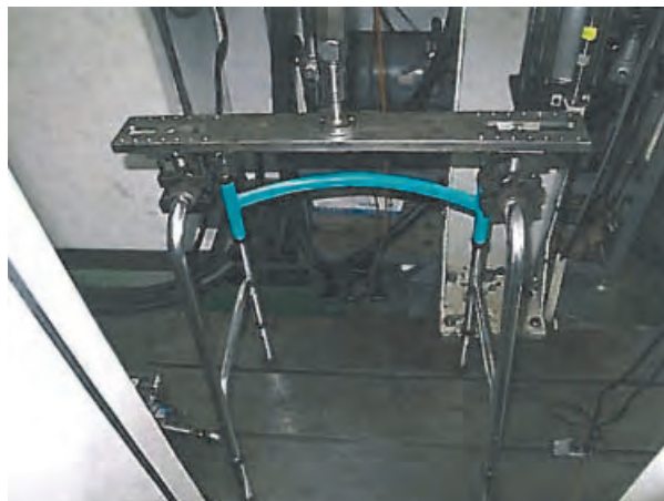
圖 25 疲勞測試執行狀態
