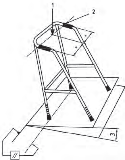
圖 16 前傾穩定性負載配置圖
