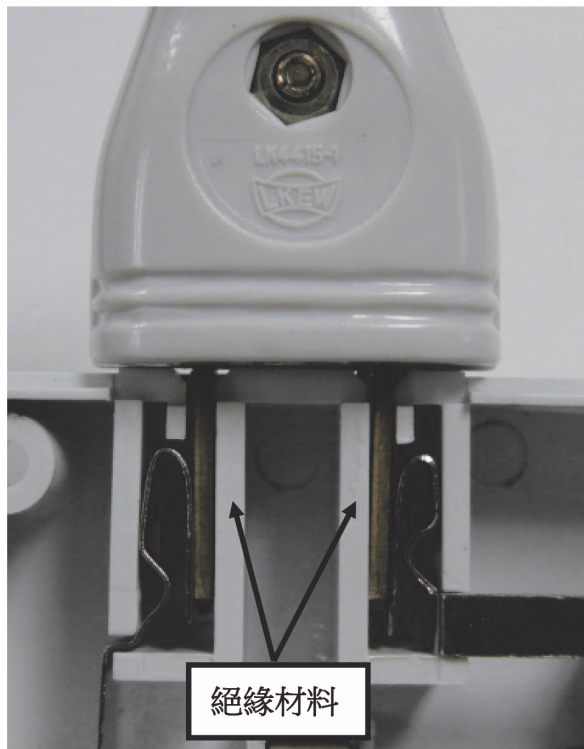
圖 5 插頭刀片之一面與絕緣材料接觸
