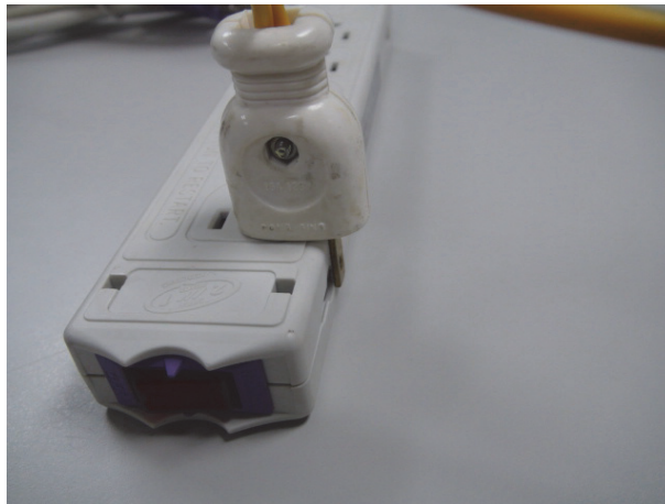
圖 4 插頭單極插入插座之情形
