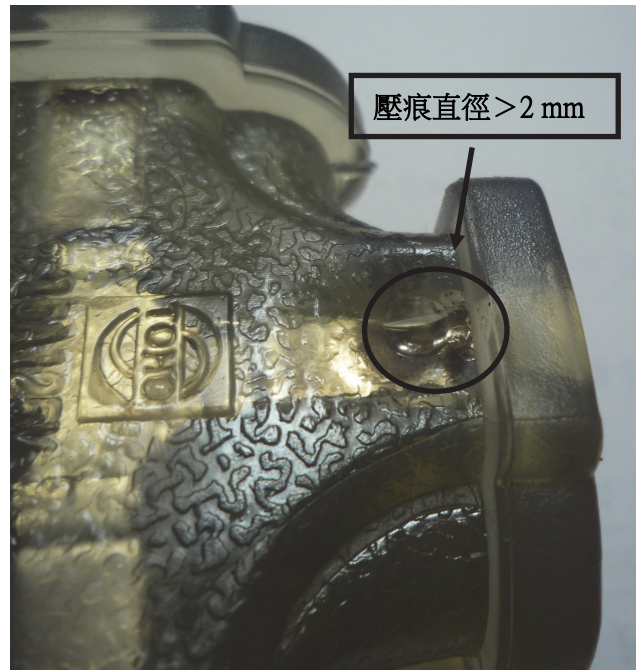
圖 10 球壓試驗之壓痕直徑大於 2 mm
