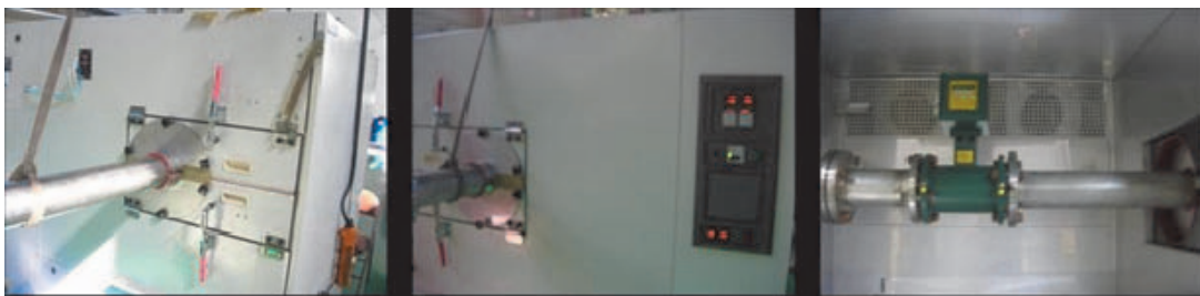
圖 1 乾熱(無凝結)試驗及濕熱循環(凝結)試驗架設圖
