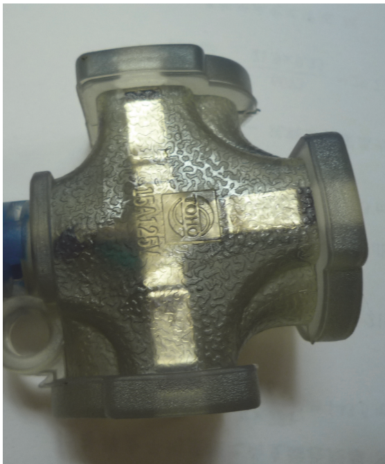
圖 9 固定載流零件之絕緣材料以 PVC 熱塑性材料製成
