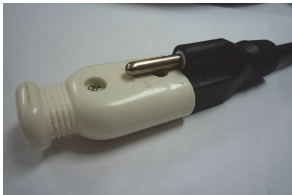
圖 1 I 類設備之插頭可與 II 類設備用之插座接合案例
