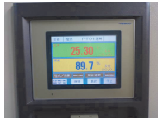
圖 3 溫濕度控制箱可執行自動化測試運轉並具有資料存取功能
