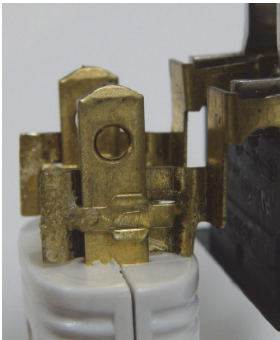
圖 8 刀座插入插頭刀片之結構
