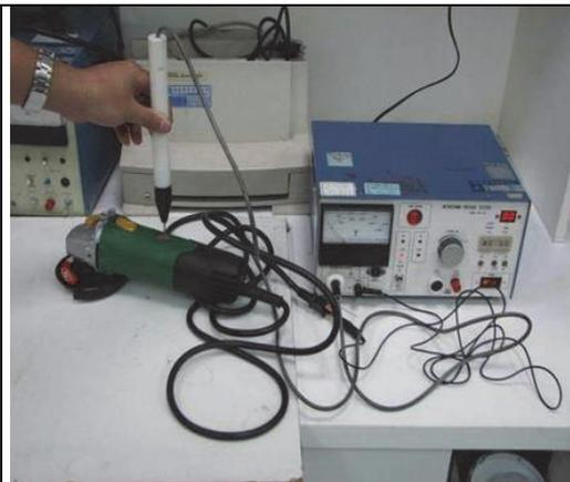
耐壓絕緣測試機
