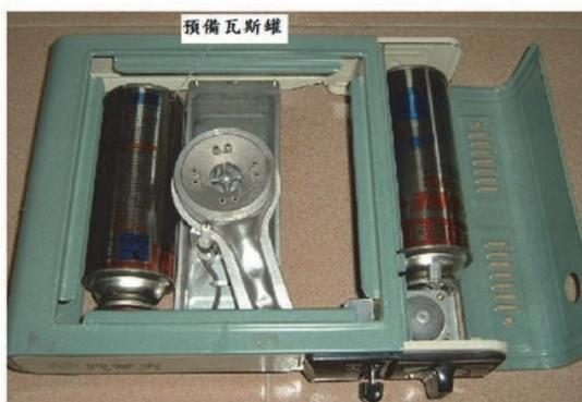
圖1 爐架下方可裝入預備容器情形
