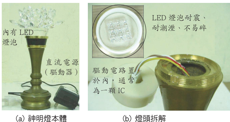
圖 3 採用 LED 光源的神明燈
