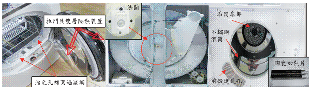
(a) 拉門及洩氣孔棉絮過濾網 (b) 支撐滾筒的法蘭結構 (c) 滾筒、進氣孔、加熱器結構
