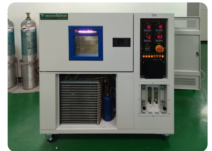
實驗室用氫氣洩漏偵測裝置性能測試系統 ▶
