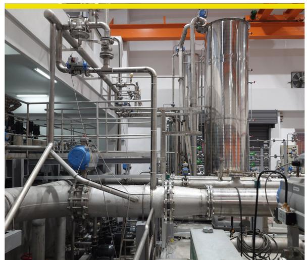
水量計檢定檢查暨型式認證測試系統
