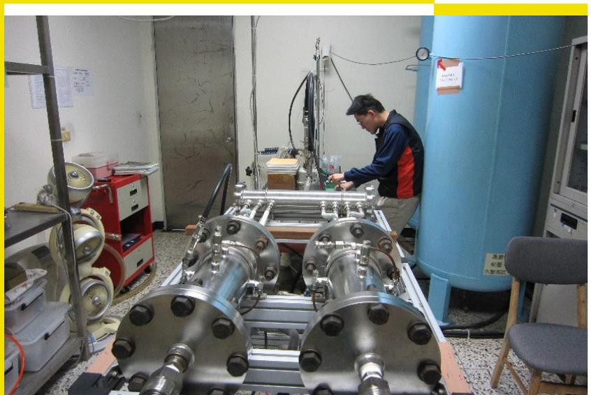
執行瓦斯表的型式認證改正測試作業
