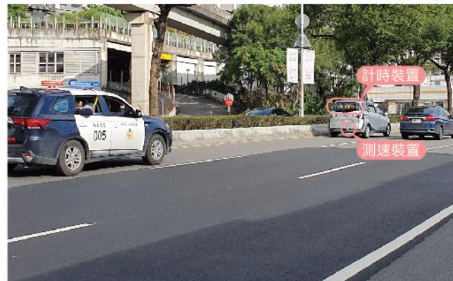
車載計時、測速裝置實車路跑執行檢測
