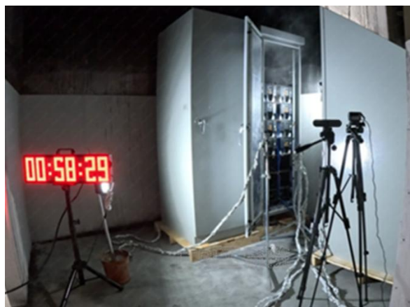
圖9 試驗過程（釋煙）
