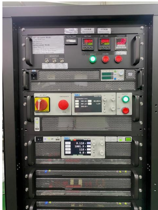
圖1 直流溫升與過負載跳脫設備
