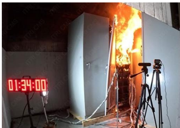
圖10 試驗過程（明火燃燒）
