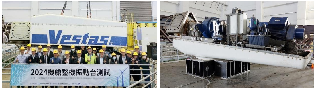
圖 3 機艙整機振動台試驗。
