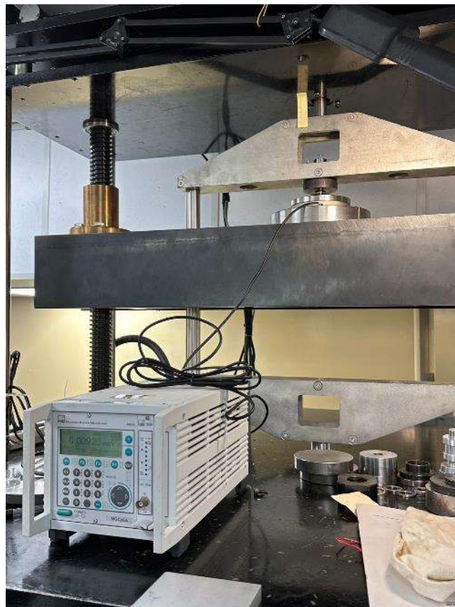
圖 1-2-9 主軸預壓力量感測器安裝至力量校正機實測畫面
