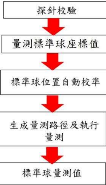
圖 2-2- 10 具機量測程序流程圖
