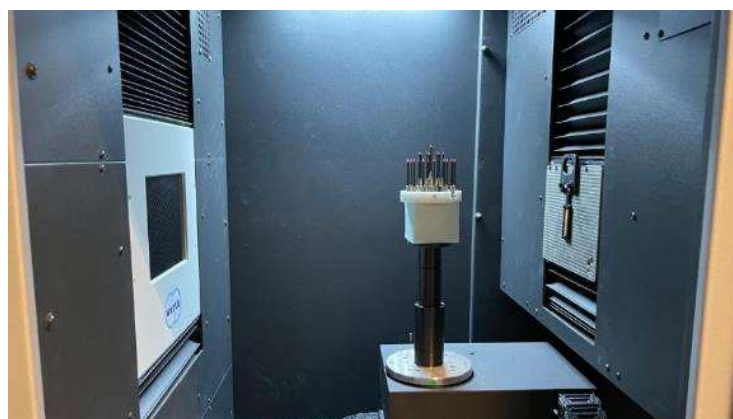
圖 4-6-1 使用 XCT 參考標準件進行 TomoScope XS PL 150 XCT 系統驗證
