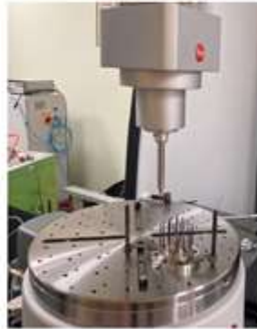
XCT 標準件實施校正程序照片
