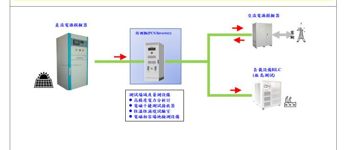
▲MW 級智慧變流器檢測系統架構及設備
