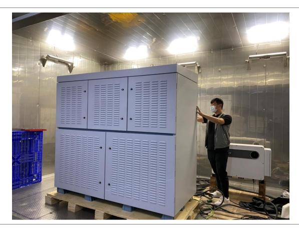
▲MW 級智慧變流器安規測試恆溫恆濕室
