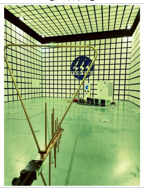
▲MW 級智慧變流器電磁相容測試場地
