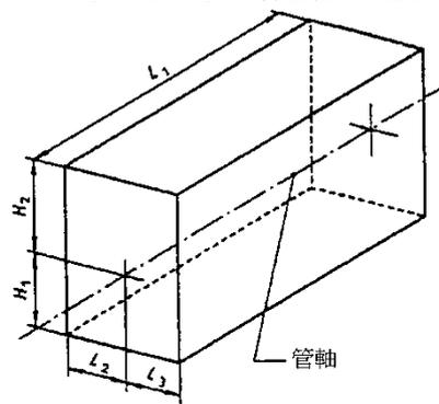
圖 A.1 水量計口徑及外形尺寸
