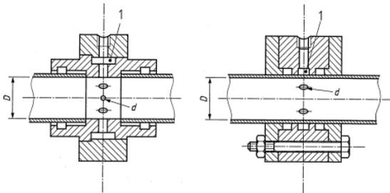
圖 2 鑽孔式測壓孔與其環室的範例
