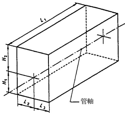
圖 B.1 水量計口徑及外形尺寸
