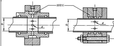
圖 A.4 鑽孔式測壓孔與其環室的範例
