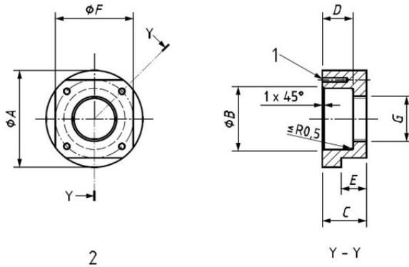
說明：1 4 個孔  $\phi J$ ，搪孔  $\phi K \times L$ 。
