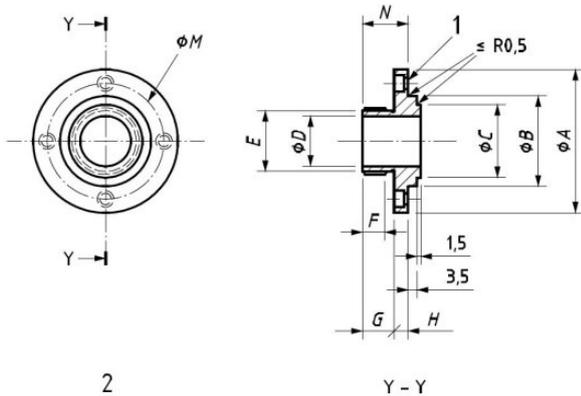
說明：1 4 個孔  $\phi J$ ，搪孔  $\phi K \times L$ 。
