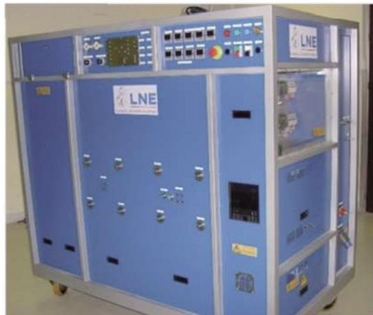
圖2 第2類(Type 2)測試氣體產生器
