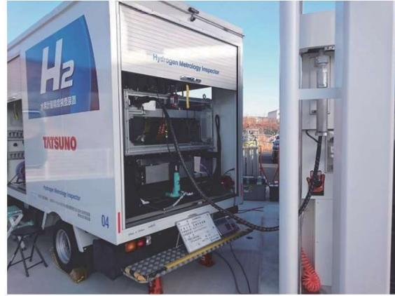
圖5 衡量法加氫計量現場 [3]
