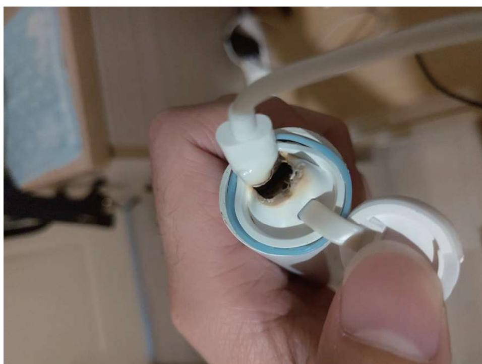
圖3 電動牙刷充電輸入端燒焦案例[4]
