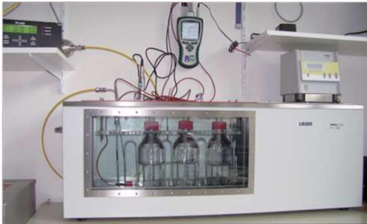
圖1 第1類 (Type 1) 測試氣體產生器
